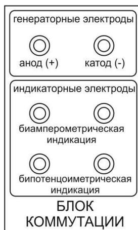
Рис. 3. Внешний вид блока коммутации (часть измерительного преобразователя) Генераторные электроды ( анод к красной клемме «+», катод – к черной клемме «-»). Подключение электродной системы по биамперометрической или по бипотенциметрической схеме соответственно.
